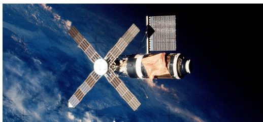
图 8.38 Skylab 2 机组成员离开时拍摄的战果——遮阳伞与展开的太阳能板
